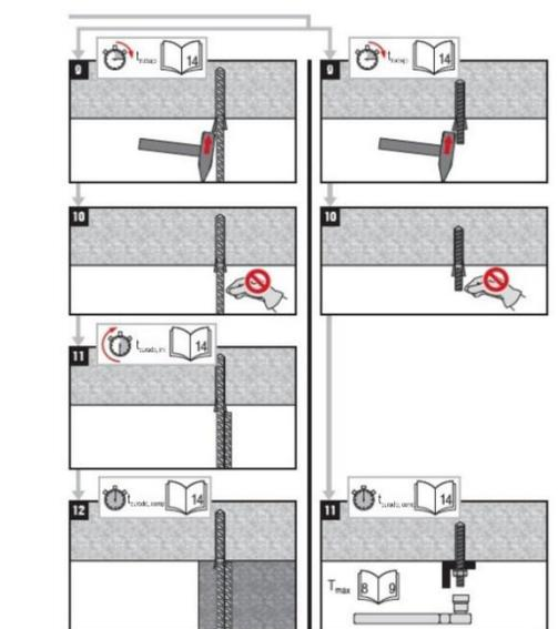
FIGURA 8A—INSTRUCCIONES DE INSTALACIÓN IMPRESAS Y PROPORCIONADAS POR EL FABRICANTE (MPII) (Continuación)
