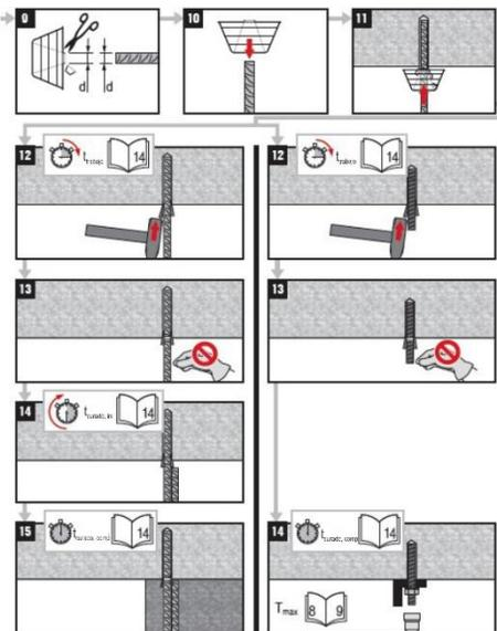
FIGURA 8A—INSTRUCCIONES DE INSTALACIÓN IMPRESAS Y PROPORCIONADAS POR EL FABRICANTE (MPII) (Continuación)
