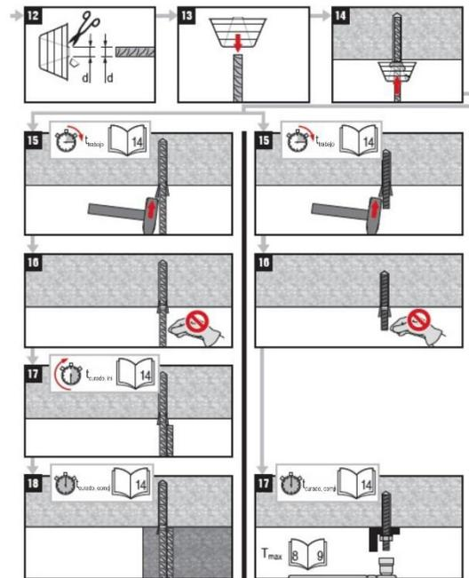
**Sistema de anclajes adhesivos para sujeción de barras de refuerzo y anclajes en concreto.**
