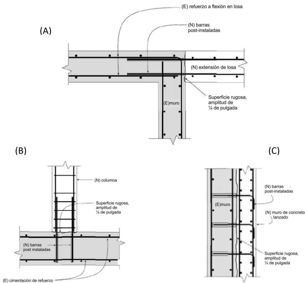
FIGURA 3—(A) EMPALME POR TRASLAPE EN TENSIÓN CON REFUERZO A FLEXIÓN EXISTENTE; (B) DESARROLLO DE TENSIÓN DE ESPERAS EN COLUMNAS; (C) DESARROLLO DE ESPERAS DE CORTANTE PARA NUEVOS MUROS DE CORTANTE SUPERPUESTOS
