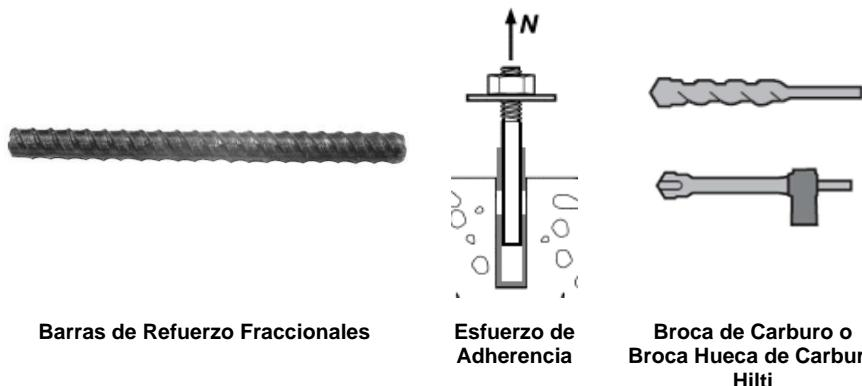
**TABLA 7—INFORMACIÓN DE DISEÑO DEL ESFUERZO DE ADHERENCIA PARA BARRAS DE REFUERZO FRACCIONALES EN AGUJEROS PERFORADOS CON TALADRO CON PERCUSIÓN Y BROCA DE CARBURO (O BROCA HUECA DE CARBURO HILTI)<sup>1,2,3,4</sup>**
