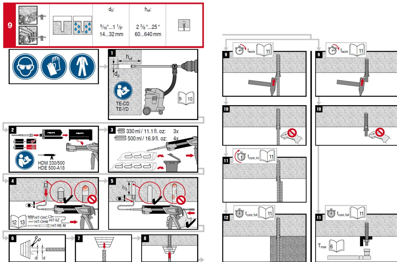
**Sistema de anclaje adhesivo para la fijación de barras de refuerzo y anclajes en concreto**
