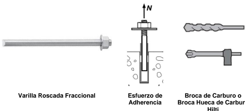
**TABLA 8—INFORMACIÓN DE DISEÑO DEL ESFUERZO DE ADHERENCIA PARA VARILLAS ROSCADAS FRACCIONALES EN AGUJEROS PERFORADOS CON UN TALADRO DE PERCUSIÓN Y BROCA DE CARBURO (O BROCA HUECA DE CARBURO HILTI)<sup>1,2,3,4</sup>**
