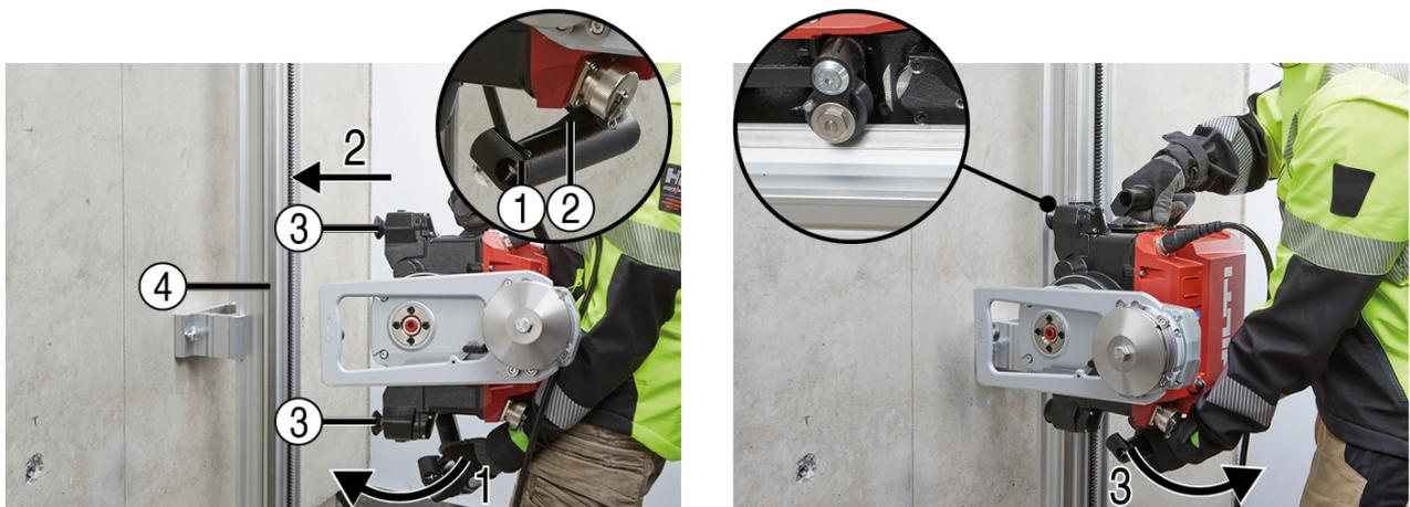
① Klemmhebel mit integrierter Entriegelungstaste
